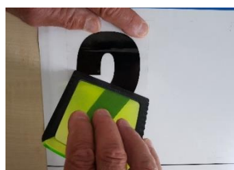
Mit einem Eiskratzer o.Ä. die Luftblasen heraustreiben
